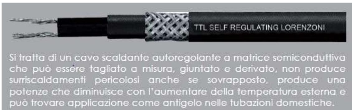
Si tratta di un cavo scaldante autoregolante a matrice semiconduttiva che può essere tagliato a misura, giuntato e derivato, non produce surriscaldamenti pericolosi anche se sovrapposto, produce una potenza che diminuisce con l'aumentare della temperatura esterna e può trovare applicazione come antigelo nelle tubazioni domestiche.
